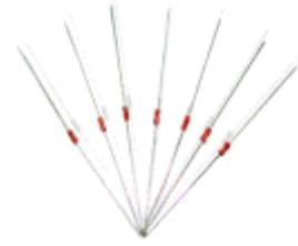
MF58 玻封测温型热敏电阻
