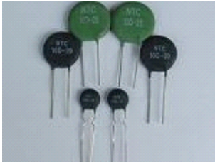
MF11 温度补偿型热敏电阻
