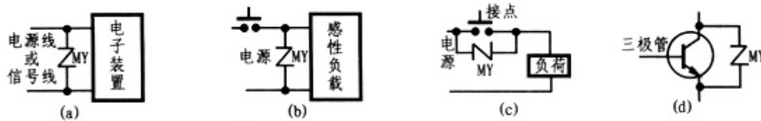
图 1 采用压敏电阻的防护连接
