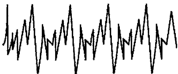
图 4.7 物体振动时会在熏了烟的玻璃上留下波形
