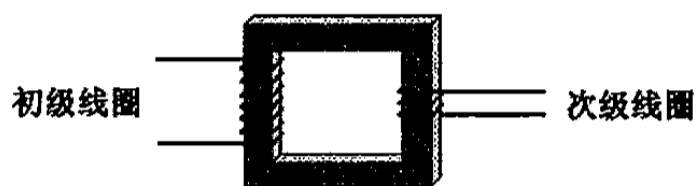
图 4.12 变压器示意图
