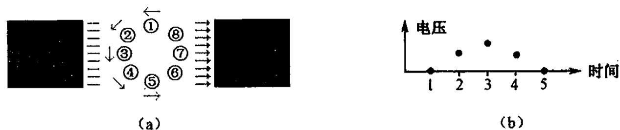
图 4.10 导体在磁场中的运动轨迹及其随时间变化的电压值
