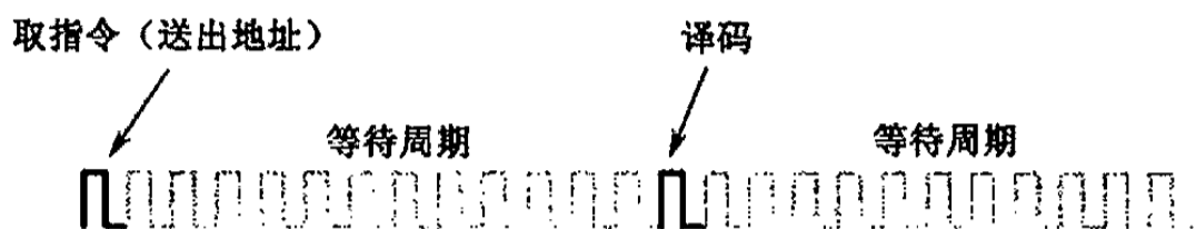
图 13.5 由于存储器的速度很慢，CPU 经常处于等待状态
