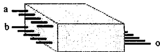
图 2.3 修改后的加法运算部件
