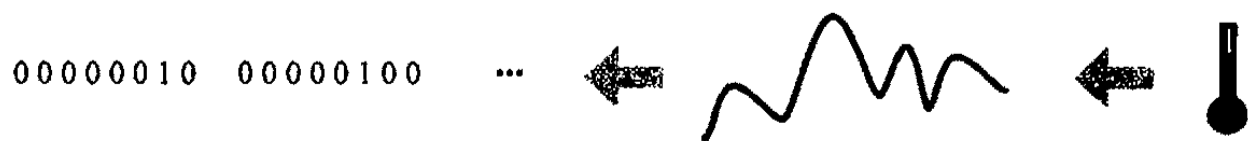
图 14.1 从温度到数字的转换过程
