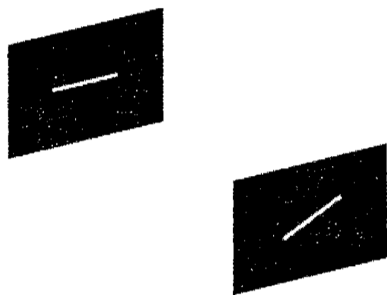
图 14.20 用液晶显示一个像素需要两个偏光片
