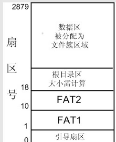
Figure 2.11: FAT 文件系统存储结构图
