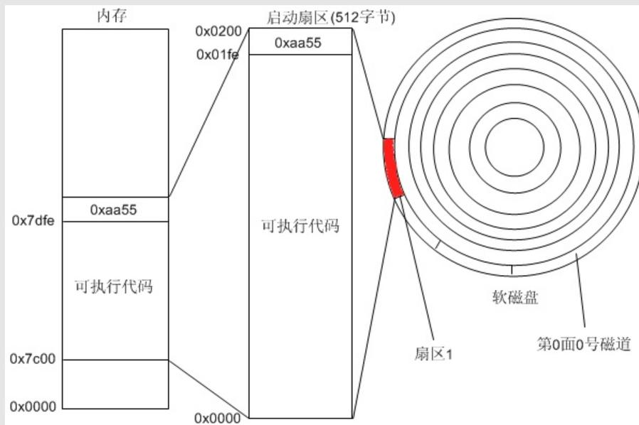
Figure 1.4: 启动扇区加载示意图
