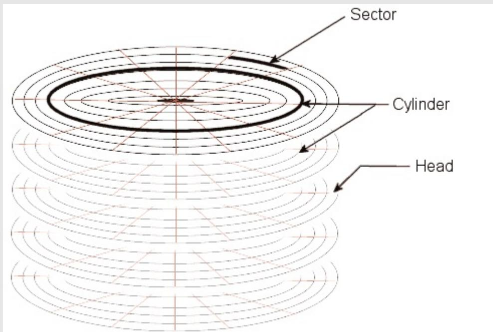
Figure 1.2: 硬盘的抽象物理结构
