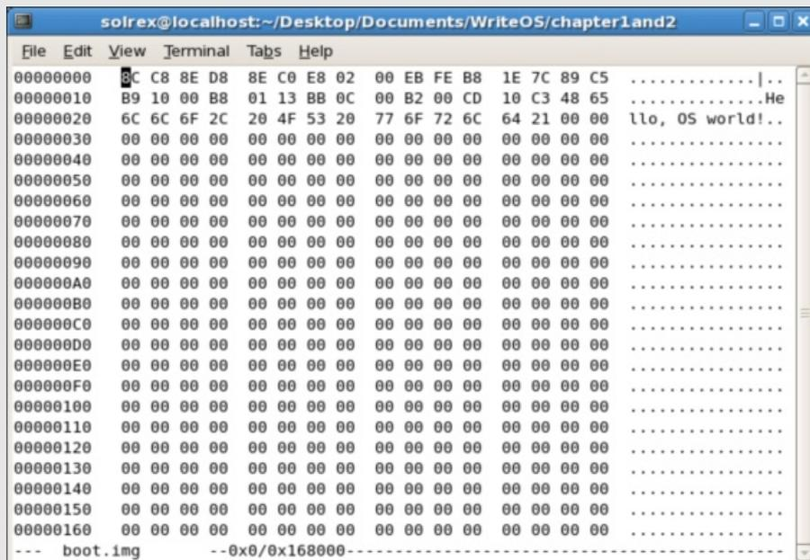
Figure 2.6: 使用 hexedit 打开 boot.img
